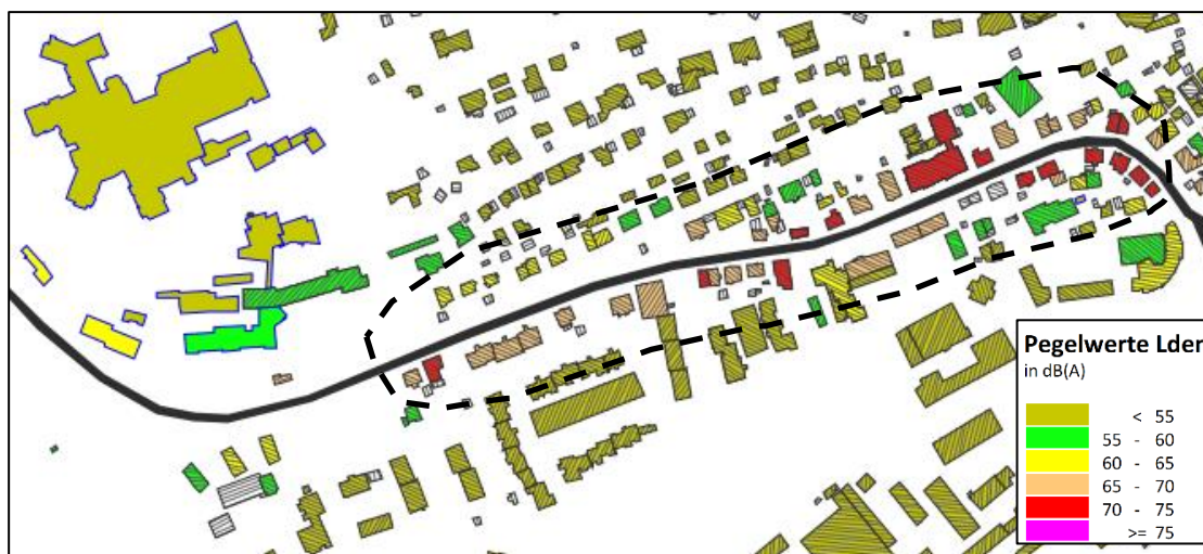
Abbildung 10 Lärmschwerpunkt 6a Riedlinger Straße – Innenstadt
