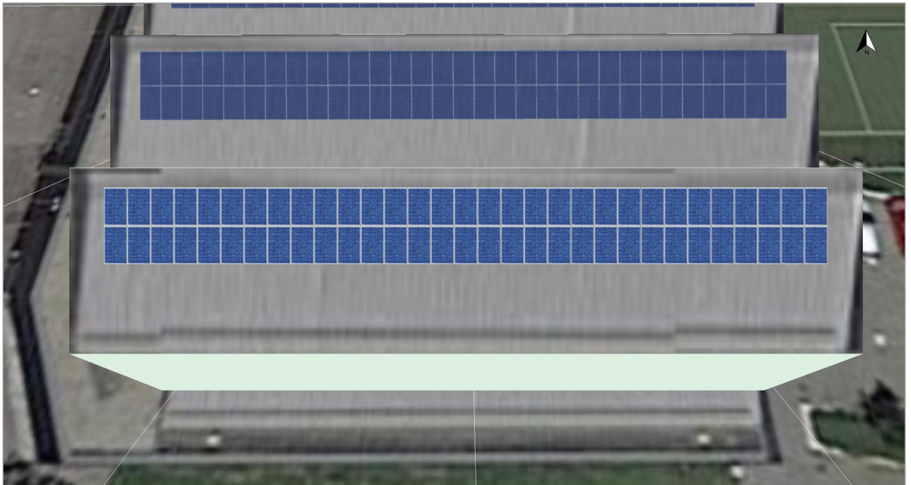
Abbildung: 4. Modulfläche - Gebäude 07-Dachfläche Süd
