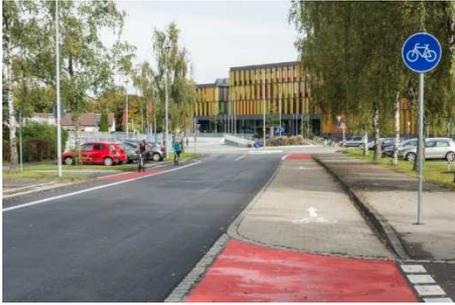
Radfahrstreifen sind durch den Breitstrich (Z 295 STVO) abgetrennte Sonderfahrstreifen. Sie sind für den Radverkehr immer benutzungspflichtig. Der Radfahrstreifen darf vom Kfz-Verkehr nicht in Längsrichtung befahren werden, er darf jedoch zum Ein- und Ausbiegen bzw. zum Erreichen von Parkplätzen überquert werden. Radfahrstreifen werden grundsätzlich im Einrichtungsverkehr betrieben.
