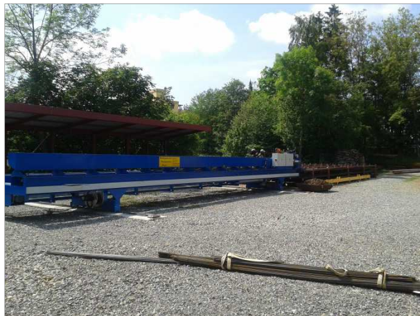
Bild 6: Neue (Rund-) Stahlschneidemaschine (Aufnahme Juni 2017, Freiaufstellung, ohne Hallenneubau)
