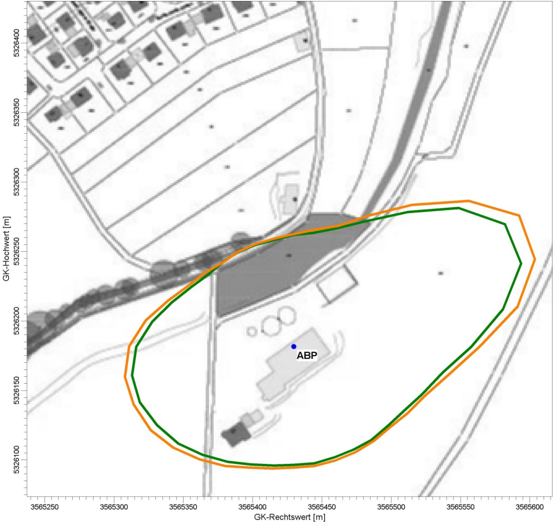
Abbildung 6. Gewichteter Mindestabstand gemäß VDI 3894 Blatt 2 (Mindestabstand WA grüne Linie; orangefarbene Linie bei einer Berechnung mit doppelten Emissionen).
