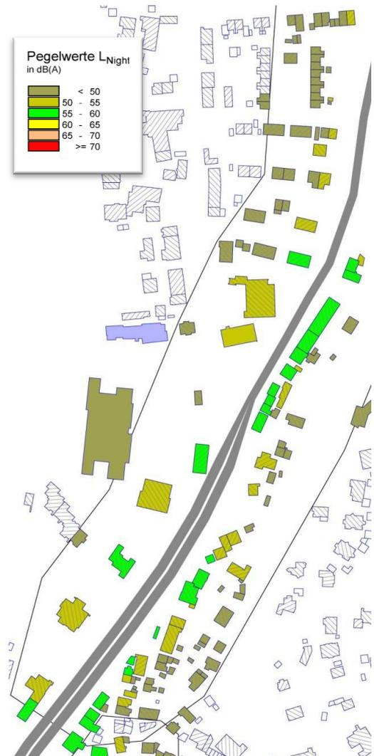
Abbildung: Austausch des Fahrbahnbelags mit lärmoptimierten Asphalt mit -3 dB(A); Darstellung des  $L_{night}$
