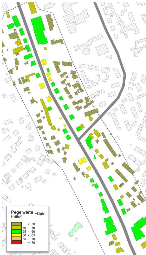
Abbildung: Austausch des Fahrbahnbelags mit lärmoptimierten Asphalt mit -3 dB(A); Darstellung des  $L_{Night}$
