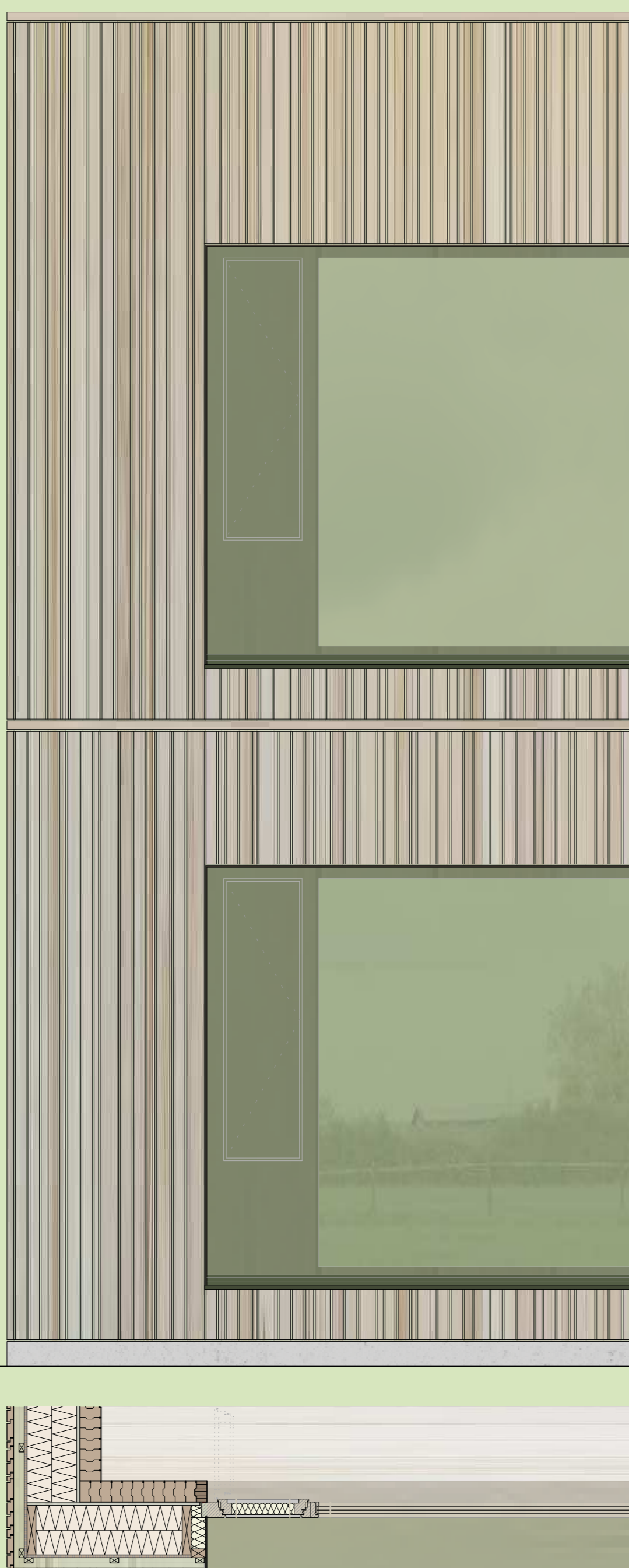
FASSADE - GRUNDRISS / ANSICHT / SCHNITT 1/25
