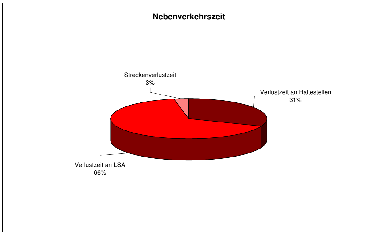
Abbildung 25 Prozentuale Zusammensetzung der Verlustzeiten Linie 6 zur Nebenverkehrszeit: Streckenabschnitt Viehmarkt – Landwirtschaftsschule / Freibad – Wie-landstraße
