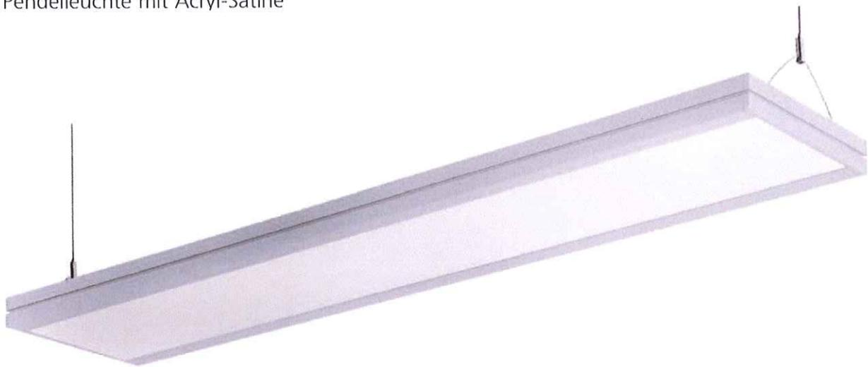
Pendelleuchte mit Acryl-Satiné für indirekte und diffus-direkte Beleuchtung für T16 Lampen. Leuchtgehäuse aus Alu-Strangpressprofil, Kopfstücke aus Aluminiumdruckguß, pulverbeschichtet in RAL 9006 struktur. 2-lampige Ausführung oben mit Makrolon-Scheibe abgedeckt. Inkl. Stahlseilabhängung (1,5 m) und transparenter Zuleitung. Max. Gewicht: 6,5 kg
