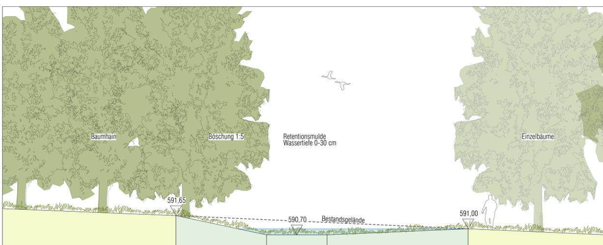
Schnitt E - Retentionsmulde durch Geländeeinschnitt
